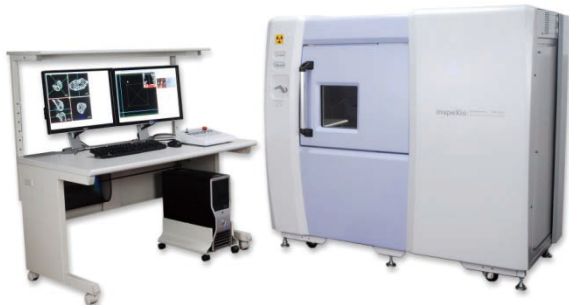
Fig. 1 新型マイクロフォーカス X 線 CT システム inspeXio SMX-100CT Overview of SHIMADZU X-ray CT System
