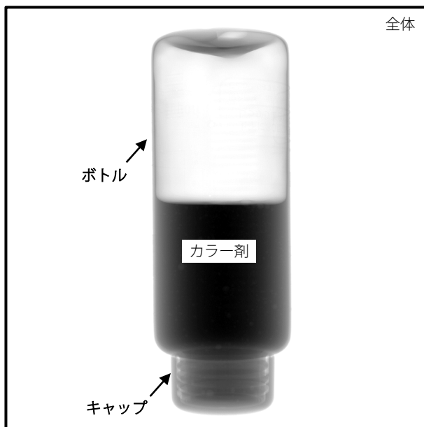
図2-A 樹脂ボトルの透視画像
