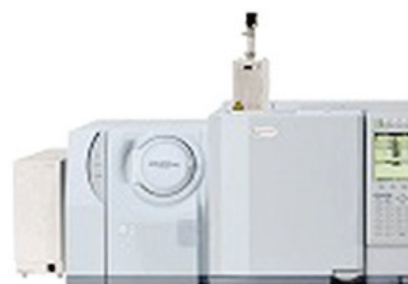
Fig. 2 Py-GC/MS の外観 Overview of Py-GC/MS
