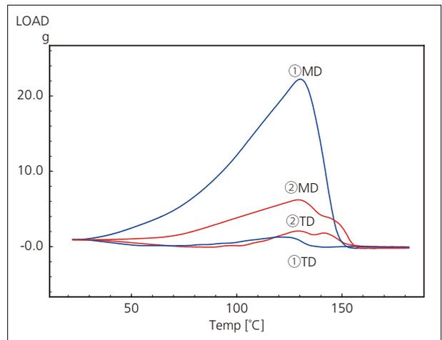
Fig. 5 セパレータのTMA測定(収縮応力)
