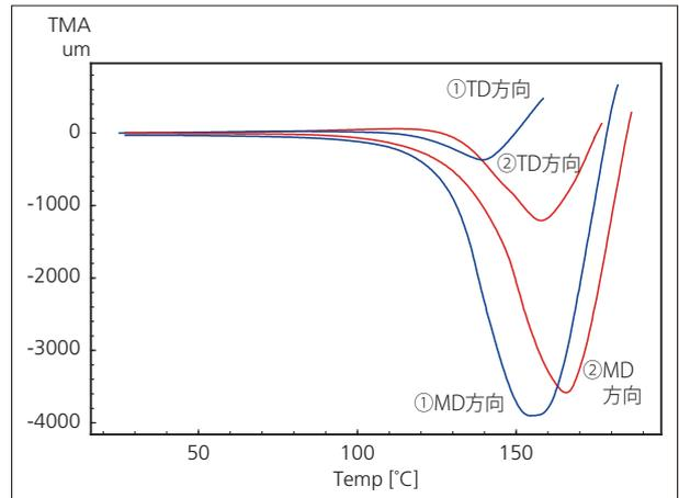
Fig. 4 セパレータのTMA測定
