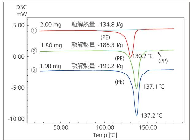
Fig. 3 セパレータのDSC測定
