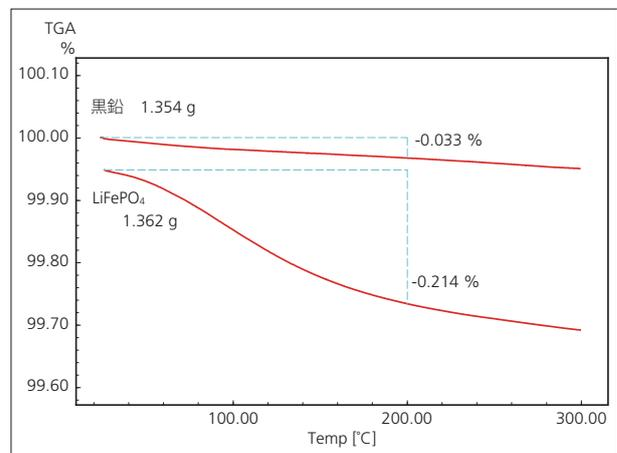
Fig. 2 電極活物質の TGA 測定
