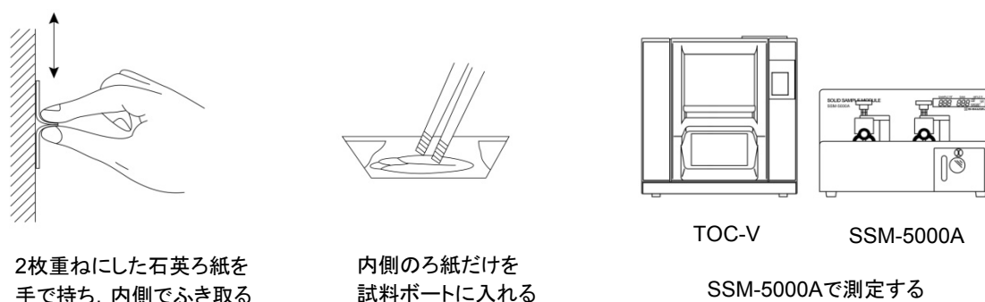
Fig. 1 スワブサンプリングー直接燃焼炭素測定法による残留物評価の手順
