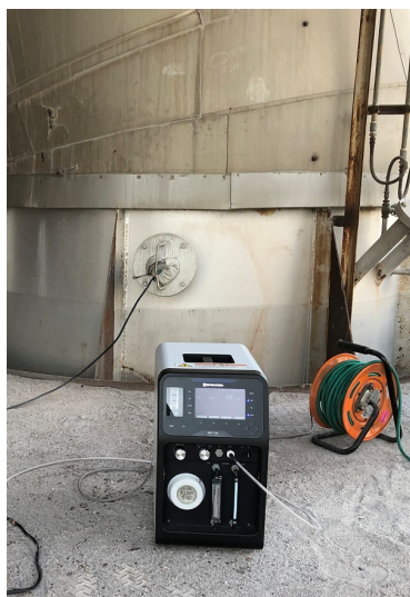
図 2 CGT-7100によるCO濃度測定の様子
