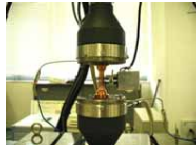
Fig.1 試験治具および変位計 Testing jig and extensometer
