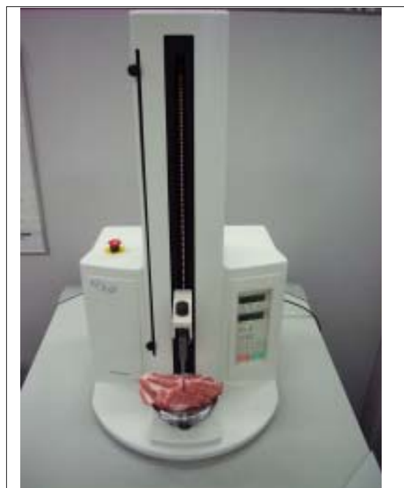
図 2 は豚肉の突き刺し強度試験の様相
