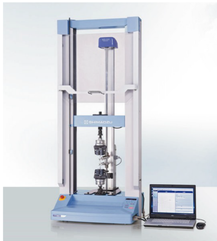
Fig.1 島津精密万能試験機 AG-X 形 外観 Overview of SHIMADZU Autograph AG-X type.
