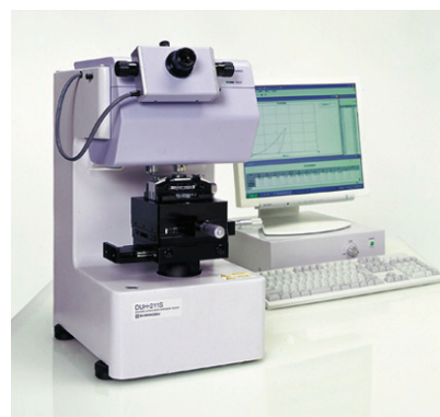
Fig.1 ダイナミック超微小硬度計 DUH-211S 形 外観 Overview of Dynamic Micro Hardness Tester DUH-211S
