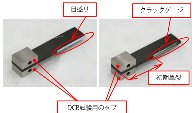
図3 試験片の写真（左：目盛り側、右：クラックゲージ側）
