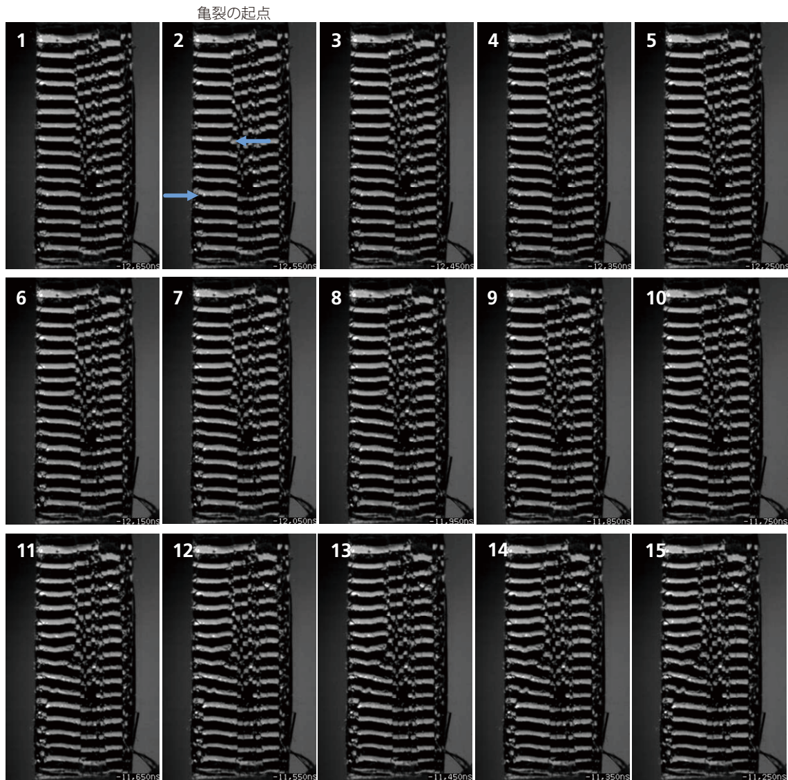
Fig.4 破断の様子② (HPV-Xにて撮影, 画像間の時間間隔は 100 ns) Image of Specimen During Fracture ② (Image of HPV-X, 100 ns between each image)
