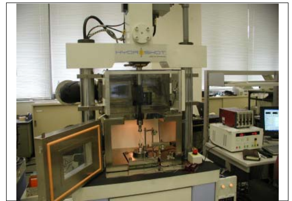
図 1 高速引張り衝撃試験機 HITS-T10
