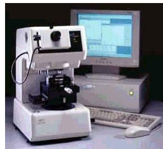
Fig.1 島津微小圧縮試験機 MCT-W500 形 外観 Overview of SHIMADZU Micro compression testing system.
