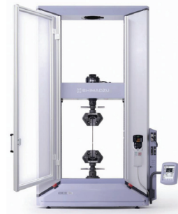
Fig.1 島津オートグラフ AG-X 形 外観 Overview of SHIMADZU Autograph AG-X
