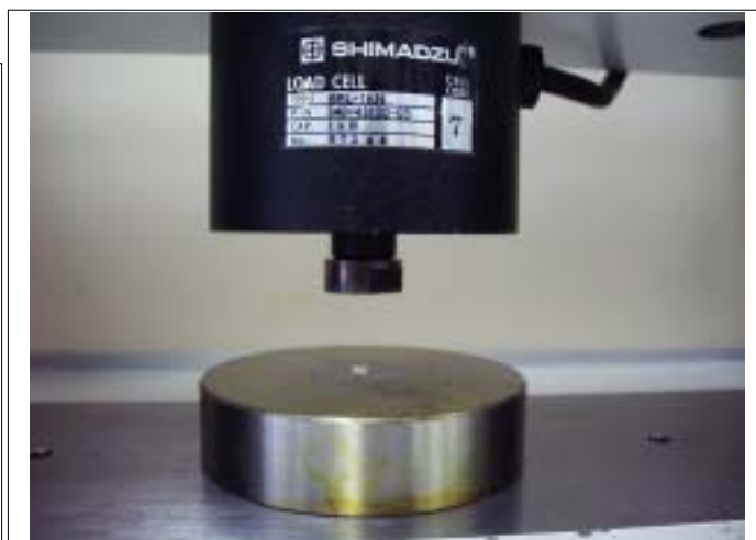
写真 1 樹脂ペレットの圧縮試験
