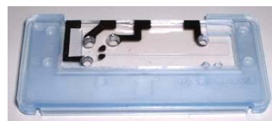
図6 MultiNA 専用マイクロチップ
