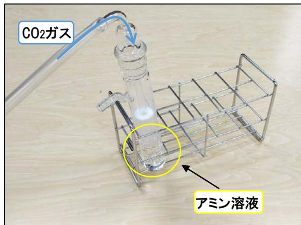
図1 アミン溶液へのCO<sub>2</sub>吸収実験の様子
