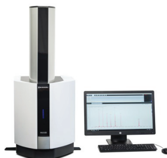
図 1 卓上型リニアモード専用装置 MALDI-8020
