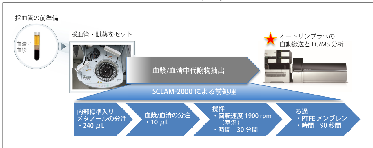
図2 LC/MS/MS システムによる代謝物一斉分析のワークフロー
