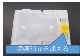
図3 生体用プレートを使用した、輸入オレンジの皮の前処理方法 プレートに挟めるものであれば、同様の方法で分析が可能。
