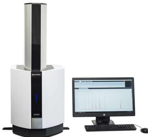
図2 卓上型 MALDI-TOF MS “MALDI-8020” 外観
