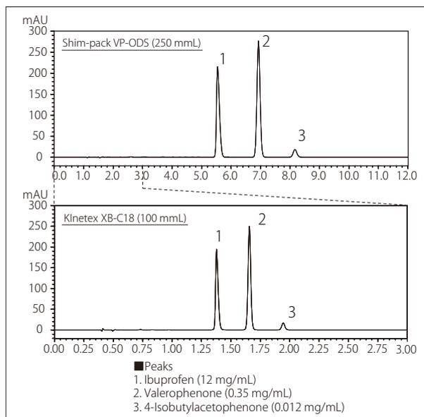
Fig. 1 Shim-pack VP-ODS と Kinetex XB-C18 シリーズの比較
