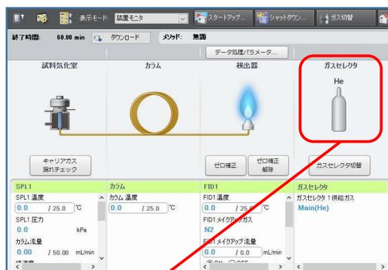
図2 LabSolutionにおけるキャリアガス切り替え機能
