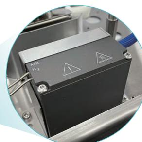
酸化 / 還元触媒マイクロリアクター **Polyarc** (据付キット含む)
