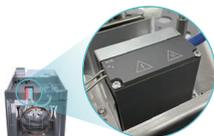
Polyarc はカラムで分離した有機化合物を全てメタンに変換する触媒リアクターです。変換されたメタンは FID にて検出されます。
