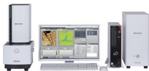
SPM-Nanoa™ 一式 (顕微鏡部、制御部、PCなど)
