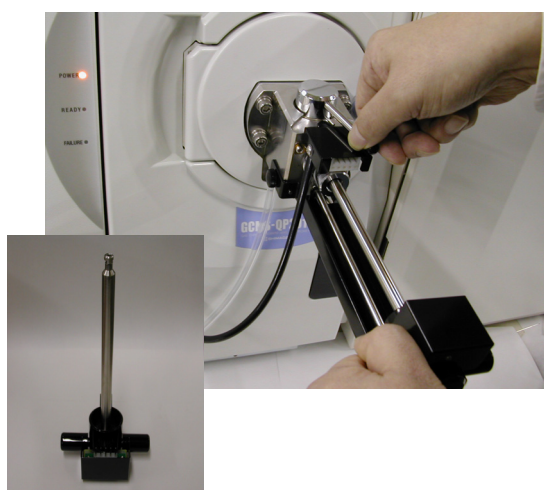
Fig. 1 直接試料導入のプローブ(左下)とプローブのMSへの挿入
