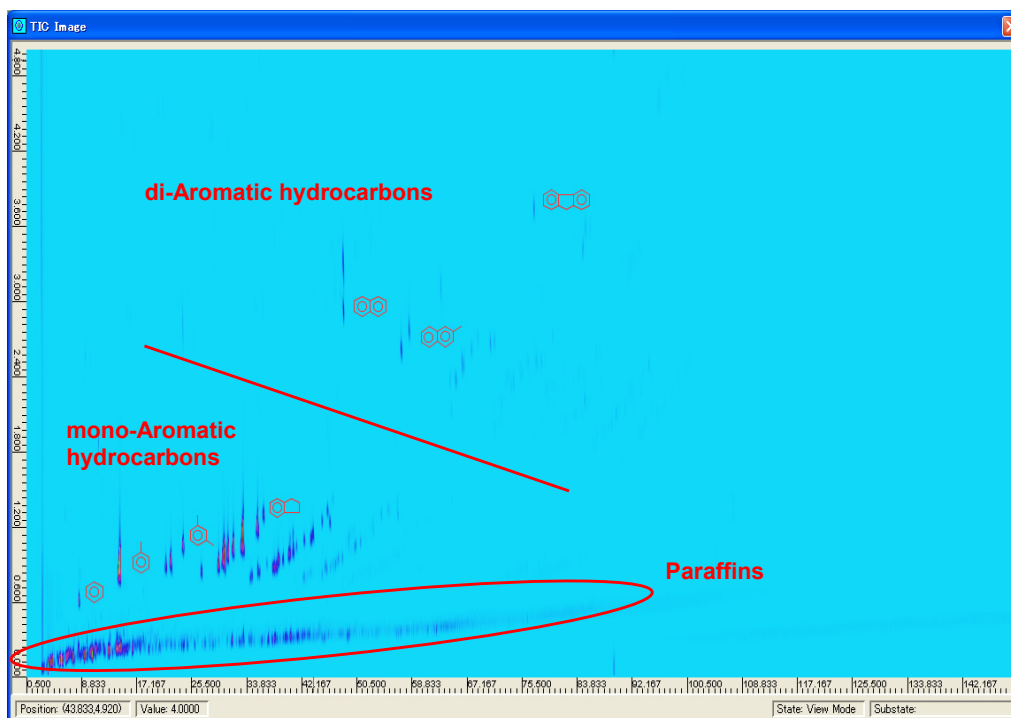
Fig. 1 レギュラーガソリンとハイオクガソリンのGC×GC-MS分析結果の2次元イメージ
