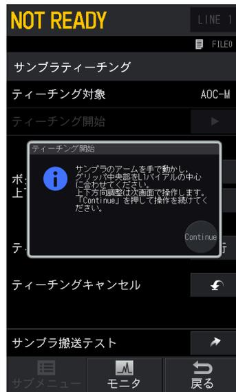
[AOC環境設定] 画面の [バイアル種類] で設定した内容に応じてオートインジェクタのターゲットが回転し、ティーチングの準備を行います。
