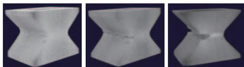
疲労き裂（初期発生状態）（進展中）（破断前）
