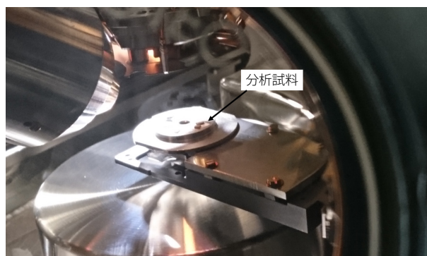
図3 大型ビューポートから観察した、サンプルホルダーと試料 (分析室内)
