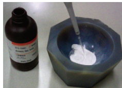
Fig. 3 標準液滴下 Blending Liquid Standard
