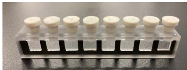
図3 8連マイクロセル(光路長1 mm)
