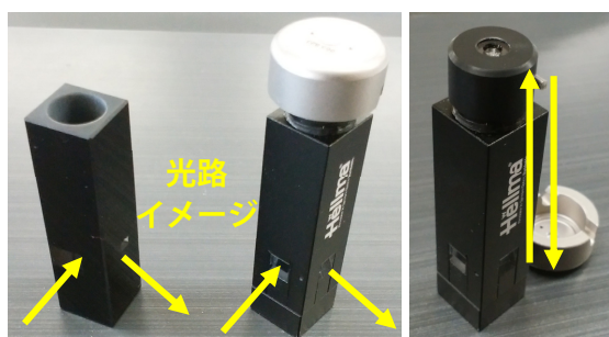
図 1 セルの外観 左：サブマイクロセル、右：TrayCell
