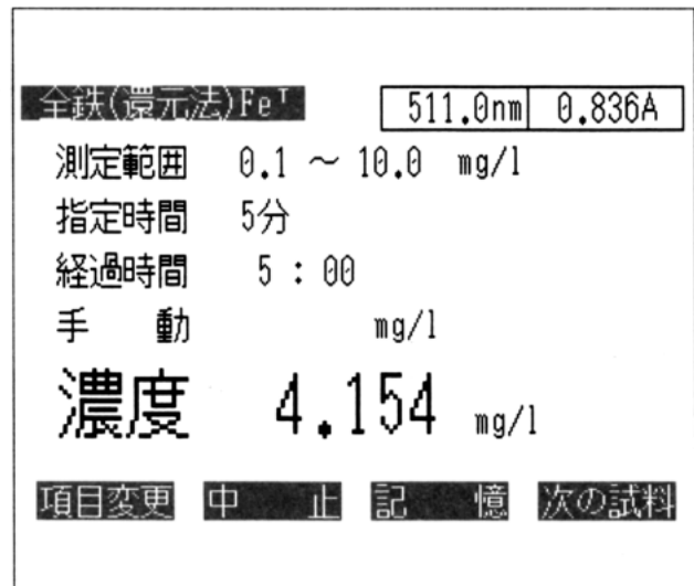
Fig.4 鉄の測定データ (試薬NO.41B) Measurement of Iron (Reagent NO.41B)
