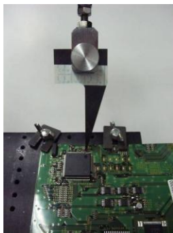
Fig.6 はく離試験の様子 Overview of peel test.
