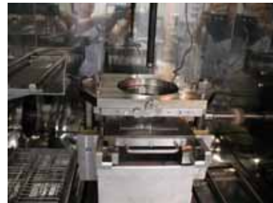
Fig.5 高速パンクチャ試験機 試料取り付け状態 Overview of testing specimen mounted on the High-speed puncture testing system
