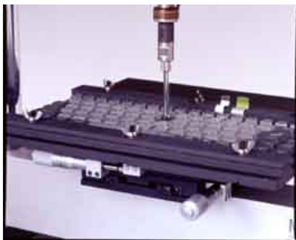
図3 キーボード圧縮サイクル試験様子
