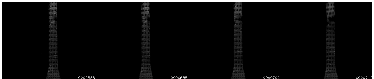
図 4 試験片が破断する様子 4 コマ (撮影速度 12 万 5 千コマ/秒)
