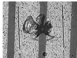
図8 平面圧子による試験
