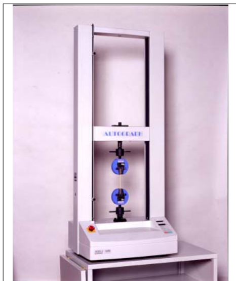
図1 島津卓上形精密万能試験機オートグラフ AGS-J 図2 犬の頸動脈の引張強度試験の様子
