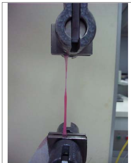
図1 島津卓上形精密万能試験機オートグラフ AGS-J 図2 犬の頸動脈の引張強度試験の様子
