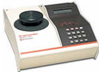
乾式自動密度計アキュピック 1330 は、試料周囲を不活性ガス(主にヘリウム)で置換し試料の体積を求める乾式法を採用しています。乾式法を用いることにより、湿式法では測定困難な粉粒体試料を測定できるのもちろんですが、液体やペーストの測定も行うことができます。今回は、3種類の懸濁液について濃度をかえて密度測定を行った結果をご紹介します。
