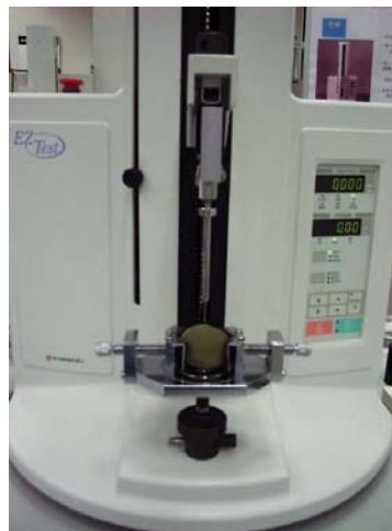
図1 漬け梅の突き刺し試験力の模様
