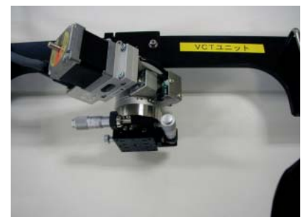
図 2 SMX-160GT に取付けた VCT-SV ユニット
