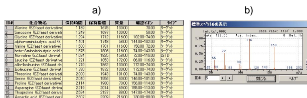
Fig.2 登録情報 a)化合物テーブル, b)標準スペクトル Contents of the method file a) Compound table b) Mass spectra (obtained from authentic sample)
