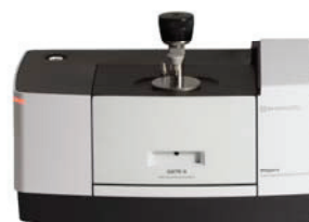
図 3 一体型 ATR QATR-S を装着した IRSpirit
