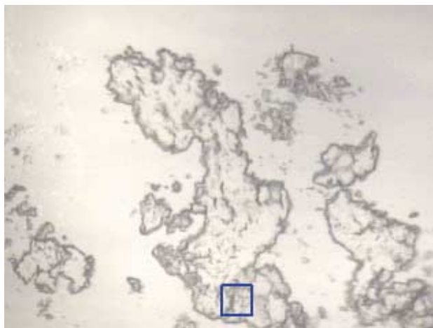
Fig.5 かき取った異物の拡大写真 Micrograph of Removed Contaminants
