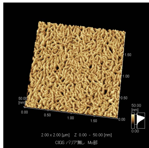
図3 SPMによるMo裏面電極表面形状観察
