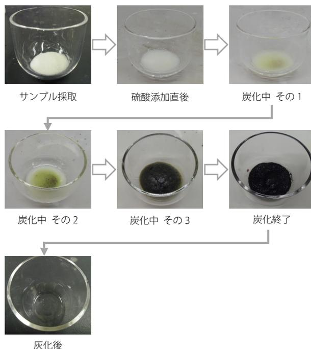
図2 炭化処理中と灰化後の試料の写真
