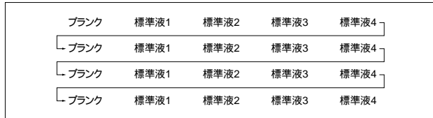
Fig.4 併行試験(定量下限値を求める)における検体の測定順序(2001上水試験方法より) Sequence of repetition measurement for determining the lower quantitative limit
